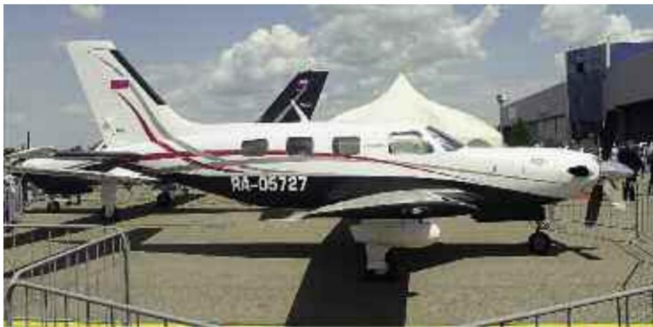
ров в час, но дальность полета у него меньше и составляет 1852 километра. Перечисленные самолеты оснащены разными двигателями: на М350 установлен Lycoming TIO-540-AE2A мощностью 350 лошадиных сил, а на М500 — Pratt Whitney PT6A-42A мощностью 500 лошадиных сил. Но он отличается большим максимальным взлетным весом, который составляет 2310 килограмм. Для воздушных судов данного класса эта разница является достаточно существенной.
