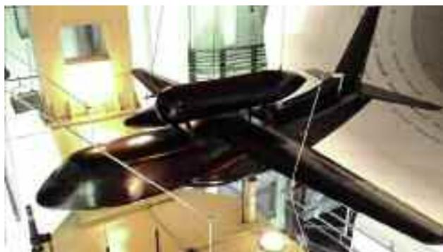
испытывали модель легкого конвертируемого самолета с внешним баком для криогенного топлива, установленным на профилированных стойках над фюзеляжем. Эксперименты проводились в аэродинамической трубе малых скоростей ЦАГИ.
