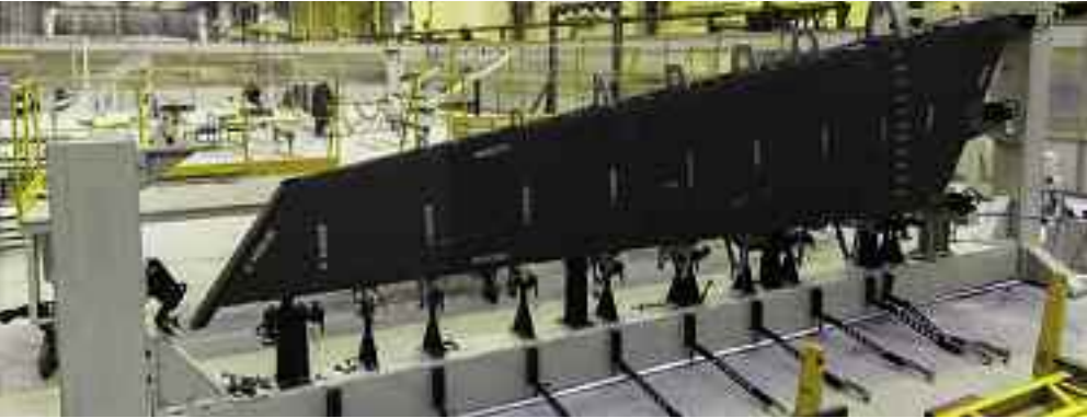
Кессон — силовая часть крыла и других элементов планера
