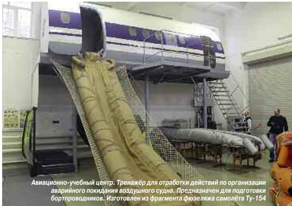
Авиационно-учебный центр. Тренажёр для отработки действий по организации аварийного покидания воздушного судна. Предназначен для подготовки бортпроводников. Изготовлен из фрагмента фюзеляжа самолёта Ту-154
