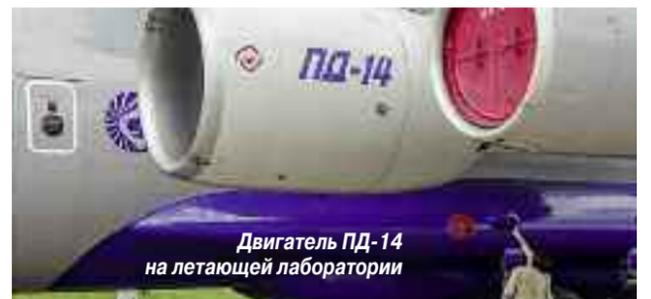
Двигатель ПД-14 на летающей лаборатории
