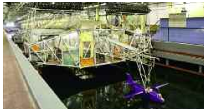
Гидроканал ЦАГИ. Исследование тематической модели 15-местного регионального самолета-амфибии
