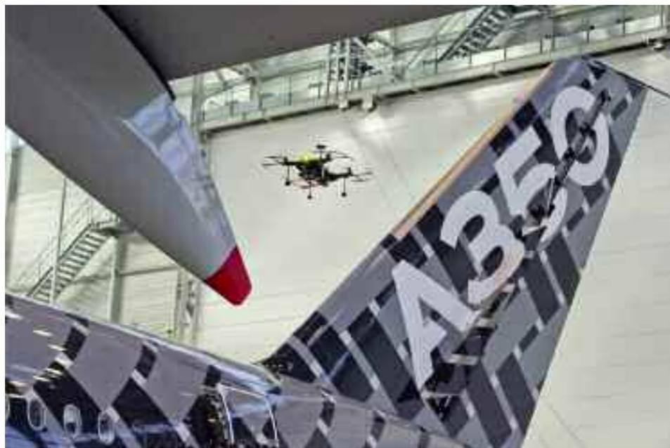
мой. Данная программа сопоставляет текущие изображения с цифровым макетом самолета, позволяя оперативно выявить и оценить визуальные повреждения самолета, если такие имеются, а также автоматически выпустить инспекционный отчет по итогам проверки.
