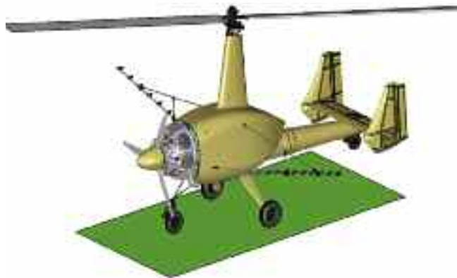
Сельскохозяйственный БПЛА автожирного типа взлетным весом 800 кг. (базовая модель)
