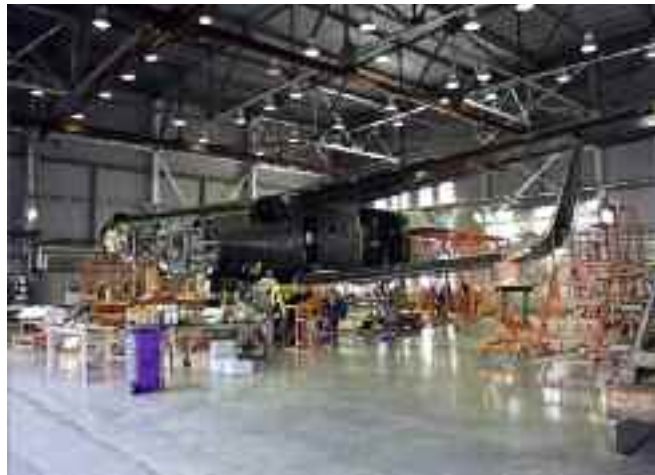
Стыковка крыльев с фюзеляжем на самолёте ТВС-2ДТС, фото — И. Прудухина (СибНИА)
