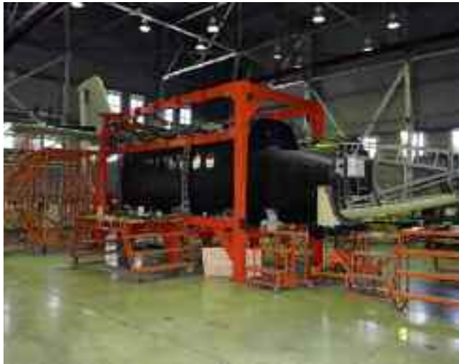
Фюзеляж ТВС-2ДТС на этапе сборки, фото — Ан. Калюта (СибНИА)
